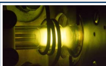
La torche à plasma du spectromètre de masse ( T : 8000^{\circ}\text{C} ). (photo, IRAMAT-CEB/CNRS)
