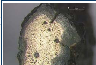
Observation de la coupe du flan monétaire de Marseille MAR31 (bronze au plomb) à la loupe binoculaire. On distingue une épaisse couche de corrosion et des nodules de plomb, en gris, dans la partie interne métallique. (photo, IRAMAT-CEB/CNRS)
