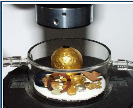
Objets équatoriens en or dans la cellule d'ablation laser du spectromètre de masse à plasma (LA-ICP-MS). (photo, IRAMAT-CEB/CNRS)
