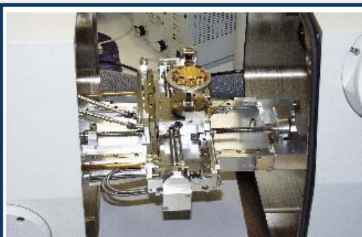
Chambre d'analyse du microscope électronique à balayage (ESEM). (photo, IRAMAT-CEB/CNRS)
