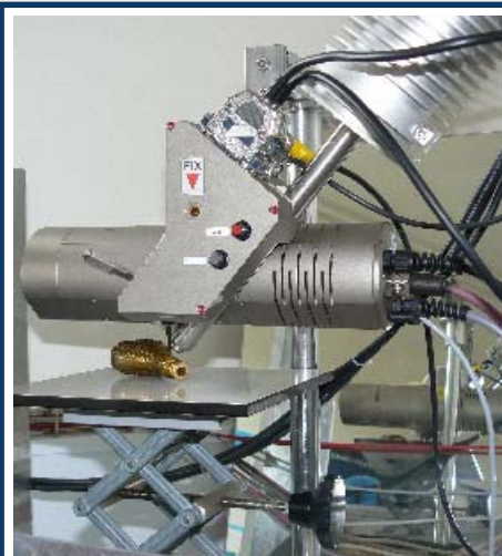
Etude de la collerette en or d'un flacon de verre attribué à Bernard Perrot par le système de fluorescence X portatif. (photo, IRAMAT-CEB/CNRS)
