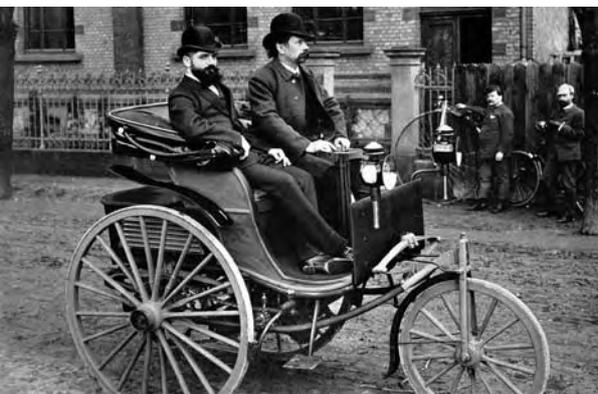
Der Patent-Motorwagen von Carl Friedrich Benz (hier am Steuer einer Weiterentwicklung) hatte knapp ein PS Leistung und fuhr maximal 16 km/h.
