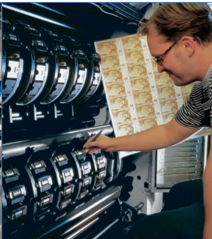
Een nummerpers. Elk bankbiljet is voorzien van een uniek serienummer.
