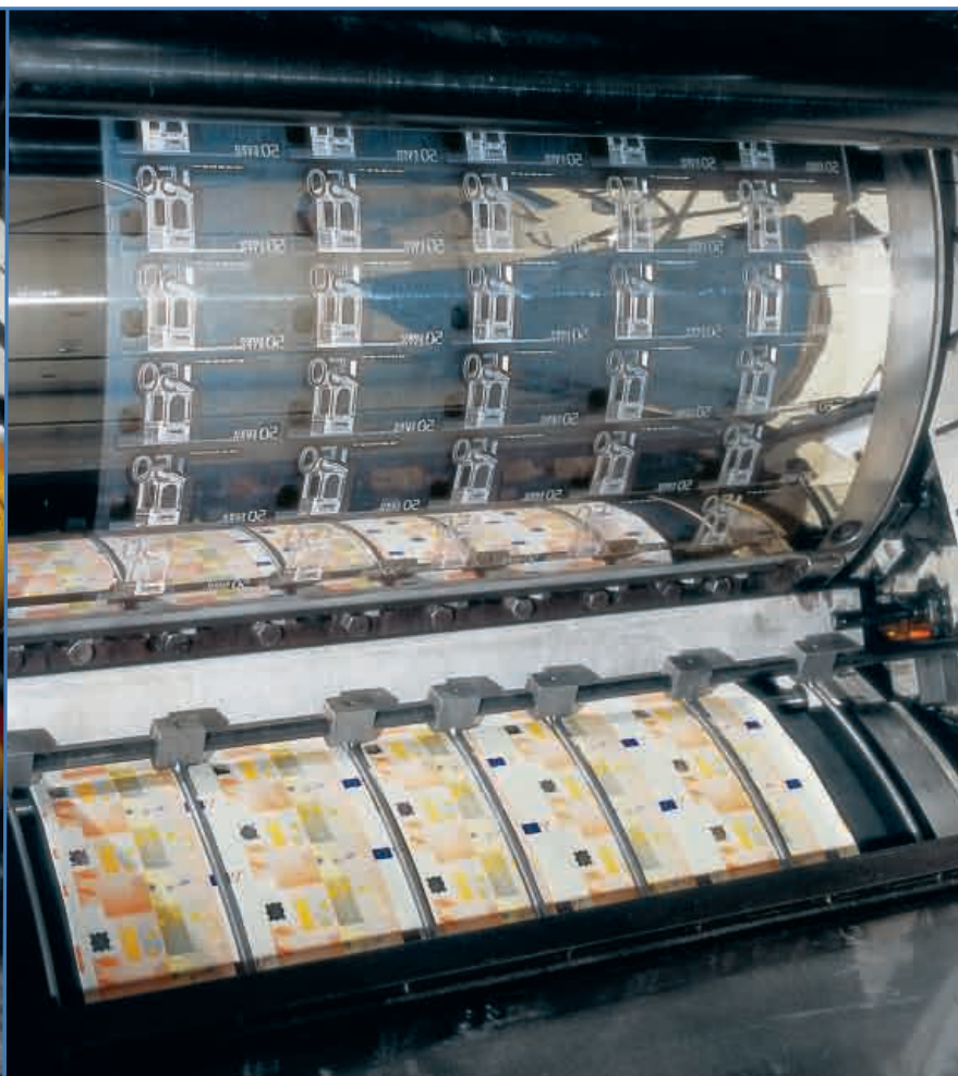
Drukcilinder voor het drukken van € 50-biljetten in een plaatdrukpers.
